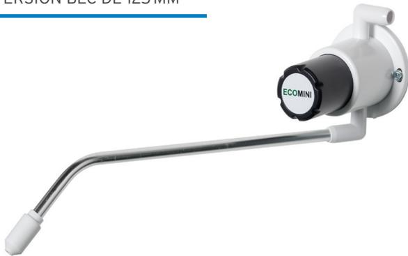
**ECOMINI** est une pompe actionnée par un bouton poussoir conçue pour doser du détergent directement depuis un conteneur dans un évier de cuisine professionnelle. Il distribue une dose fixe de 30 ml par l'intermédiaire d'un bec de sortie de 125 mm anti-goutte. Un bec plus long de 300 mm est également disponible. Il peut passer d'un évier à l'autre, permettant l'utilisation d'une seule pompe. Le bouton poussoir a été conçu pour adopter le même design que l'ECO RANGE.
